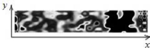
Рис. 2. Визуализация распространения полос Людерса по длине образца триметалла при общей деформации: 0,8% (а) и 1,2% (б)
