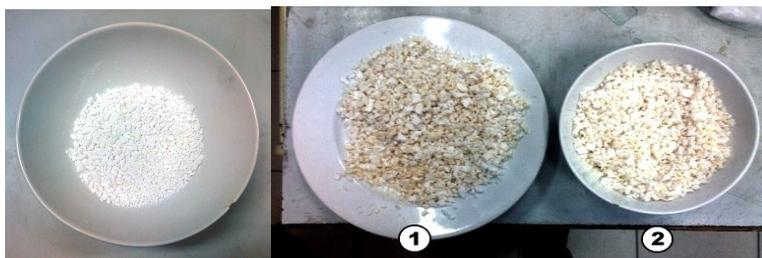
Рис. 3 — Изменения в окраске адсорбента по высоте картриджа: 1 — адсорбент из дна картриджа; 2 — адсорбент с середины картриджа
