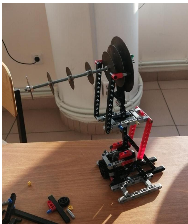
Рис. 3. Направленная антенна, закрепленная на подставке
