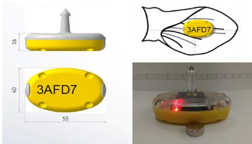
Рис.2. Ушная бирка LoRaWAN
