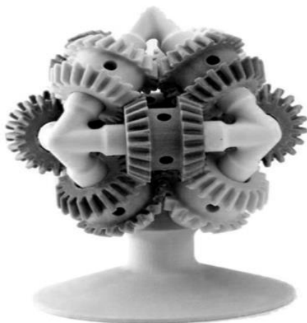
Рис. 1. Редуктор, изготовленный на установке быстрого прототипирования в уже собранном виде
