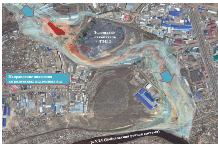
Рис. 1. Гидрогеологическая модель движения грунтовых вод.
