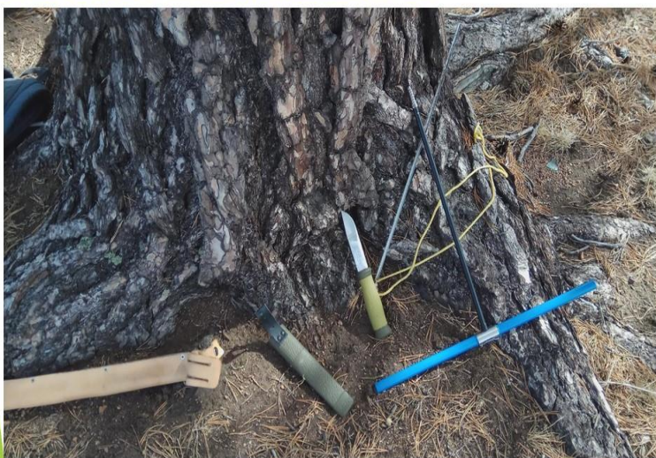
Бурав Пресслера – приростной бурав специализированный дендрохронологический инструмент для взятия проб из ствола живого и неживого дерева с минимальным вредом для него
