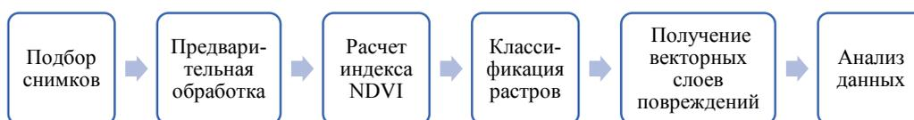
Рисунок 1 — Алгоритм проведения анализа повреждений
