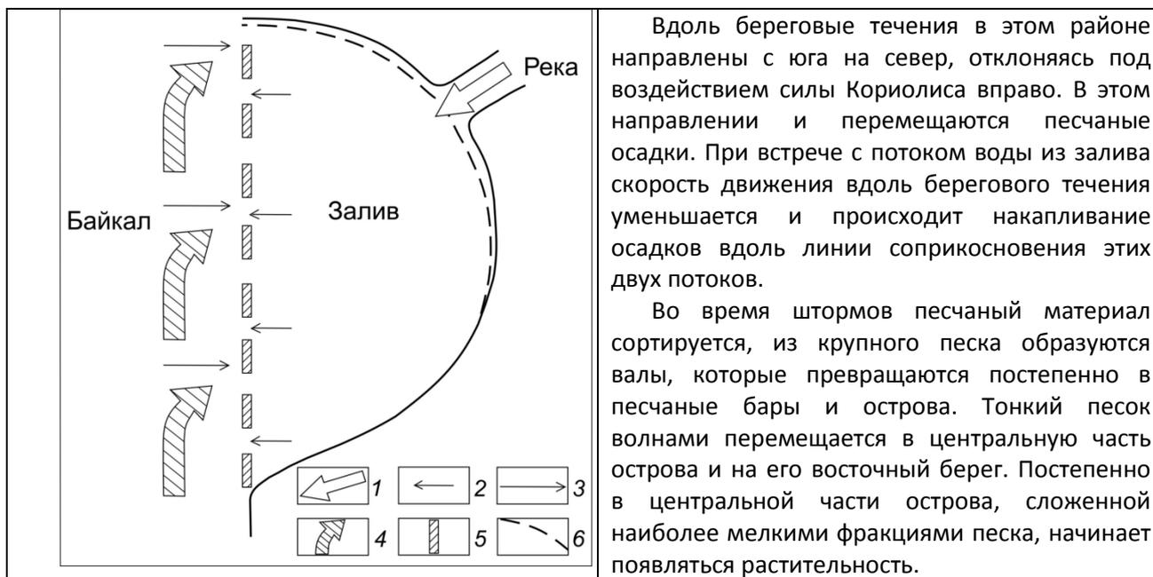
Рис. 2. Схема формирования островной дуги в заливе Сор-Черкалово. Условные обозначения: 1 – поток воды из реки, 2 – направление движения воды из залива, 3 – направление движения волн, 4 – перемещение песка вдоль береговым потоком, 5 – формирование песчаного бара, 6 – отложение речных осадков
