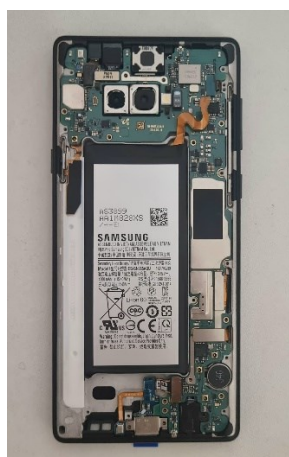
Рисунок 6. Собранный дисплейный модуль Samsung Galaxy Note 9 со всеми подключенными компонентами
