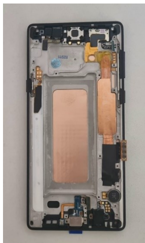
Рисунок 5. Дисплейный модуль с установленной аккумуляторной батареей и компонентами
