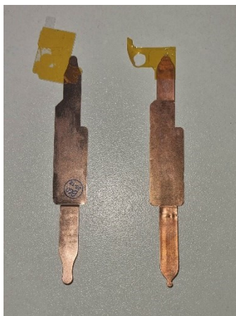
Рисунок 4. Сравнение оригинальной (увеличенной) и неоригинальной (уменьшенной) системы охлаждения
