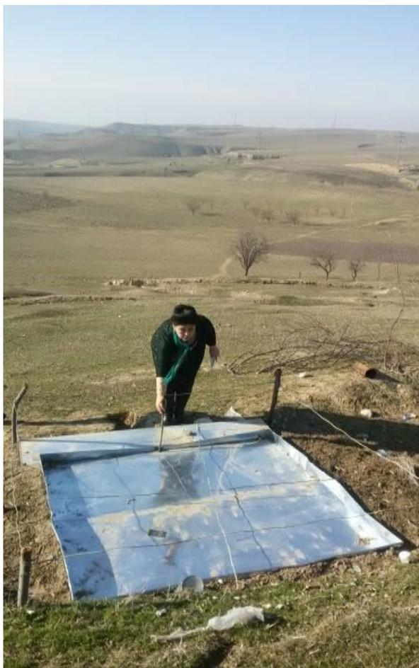
Рис. 3. Общий вид конструкции установки во время измерения уровня накопленной воды в аккумуляционном резервуаре.
