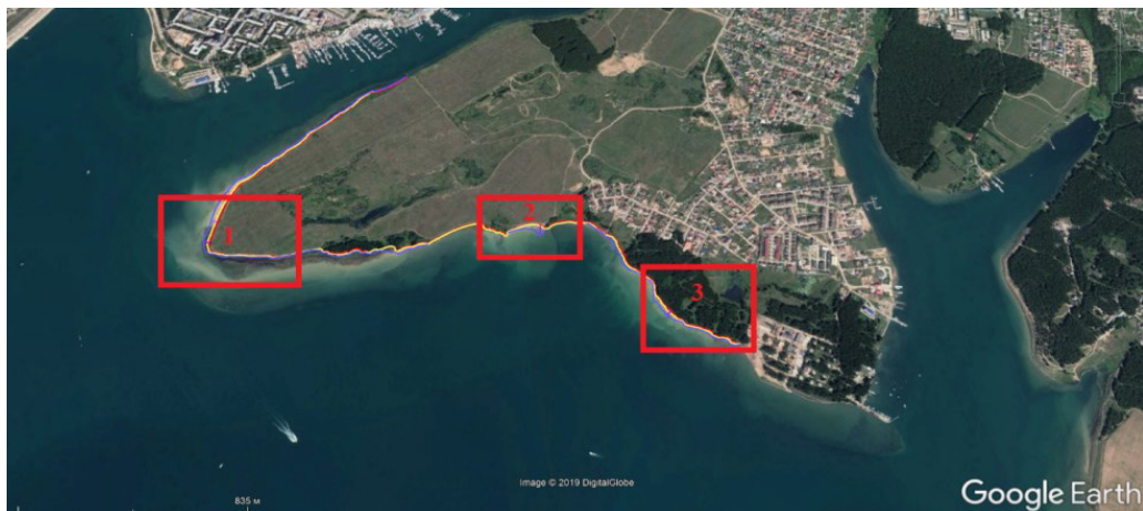
Рис. 1. Карта-схема площадки «Новая Разводная» с выявленными участками (1, 2, 3) разрушения, (основа снимка с Google Earth).
