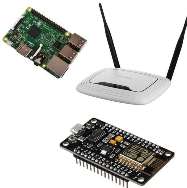
Рис. 1. Варианты исполнения: Raspberry Pi, роутер, плата ESP8266
