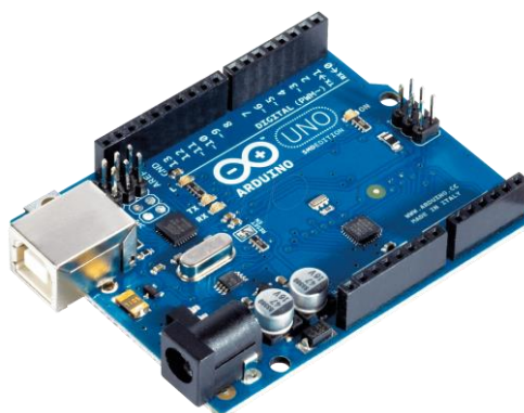
Рис. 1. Микропроцессорная система «Arduino UNO»
