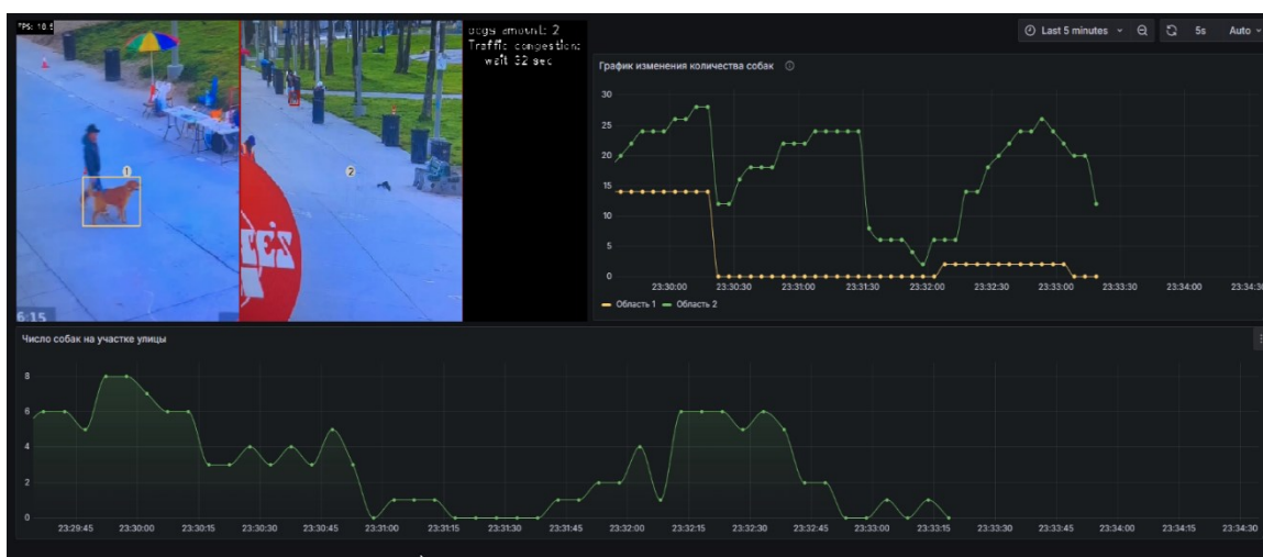
Рис. 3. Панель мониторинга с окном видеопотоков
